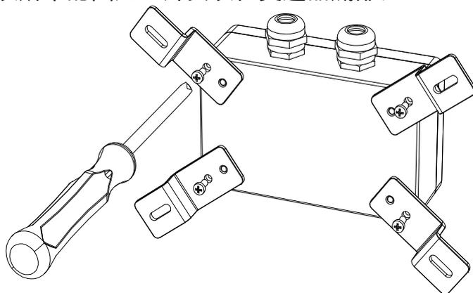
2. 通过固定垫片将变送器安装在箱体内部。
