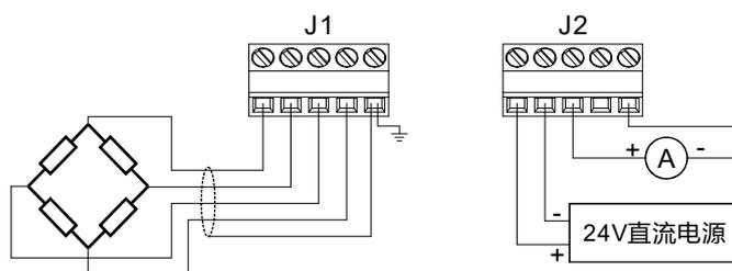
注意：传感器接线请选用带屏蔽层的专用电缆，并将屏蔽层接入J1的5脚，同时在该引脚接入电气接地点。供电电源负端与信号输出公共端不要共用一根导线。
