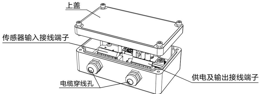
2. 将电缆线外皮剥去，露出里面芯线长度约25mm，剥开芯线绝缘外皮，露出导体约5mm，电缆屏蔽层拧成一根。旋开电缆防水接头，将电缆穿过接头，旋紧防水接头，注意电缆剥开部分不要留在接头内。。
