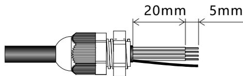
3. 用一字螺丝刀逆时针方向旋动绿色接线端子上端的螺丝，露出端子上的接线孔，将剥开的5mm导体插入对应的端子接线孔内，再顺时针旋紧端子压线螺丝。
