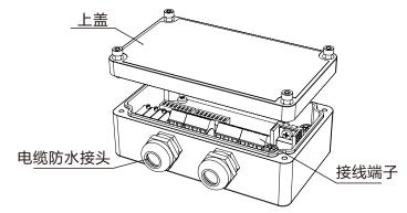
2.将电缆线外皮剥去,露出里面芯线长度约25mm,剥开芯线绝缘外皮,露出导体约5mm,旋开电缆防水接头,将电缆穿过接头,旋紧防水接头,注意电缆剥开部分不要留在防水接头内。
