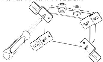
2. 通过固定垫片将变送器安装在箱体内。
